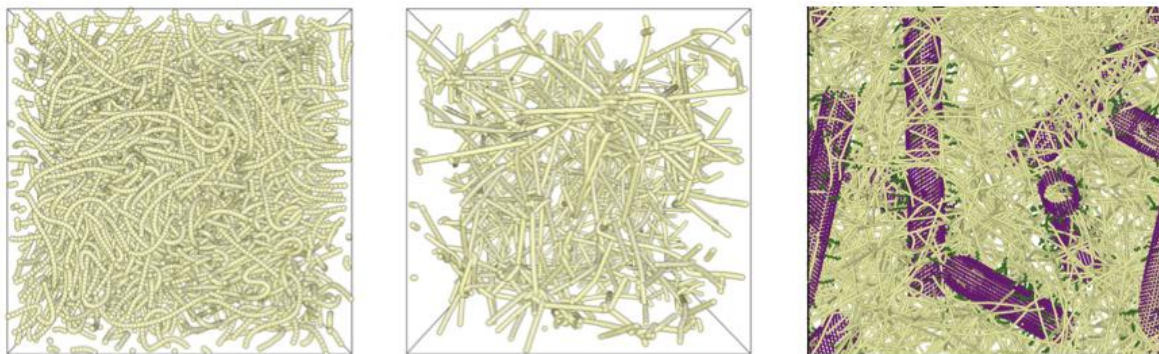
Рис. 1. Расчетная ячейка с чистым полиэтиленом (слева), его примитивный путь (по центру), примитивный путь для композита с углеродными нанотрубками (справа).
