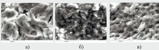
Рисунок 1 - SEM микрофотографии лигнина, эпоксилированного при 100°C в течение 1 ч (а), 3 ч (б), 5 ч (в)
