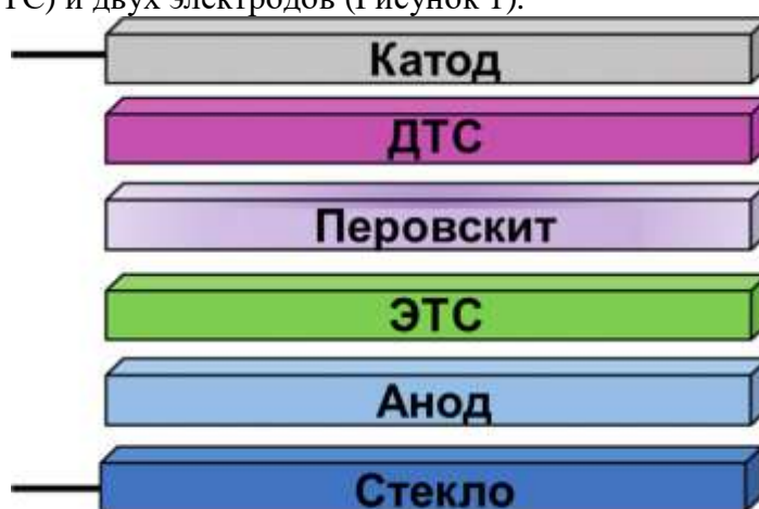
Рисунок 1. Структура перовскитных солнечных элементов.
