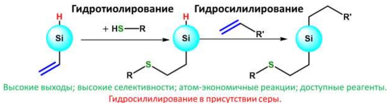
Рис.1. Общая схема последовательного гидротииолирования и гидросилилирования.
