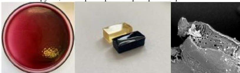
Рисунок 1. Композитная пленка на основе ПУ и комплекса железа(II), полученная прямой отливкой; композит на основе ПА и комплекса железа(II) в сравнении с чистым ПА, полученные методом 3Д-печати; изображение СЭМ композита на основе ПС и комплекса железа(II).
