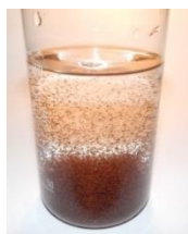
Рисунок 1. Удаление загрязненного сорбента из суспензии вода - песок методом магнитной сепарации.
