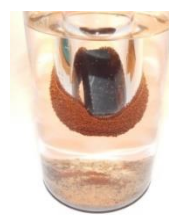
Рисунок 1. Удаление загрязненного сорбента из суспензии вода - песок методом магнитной сепарации.
