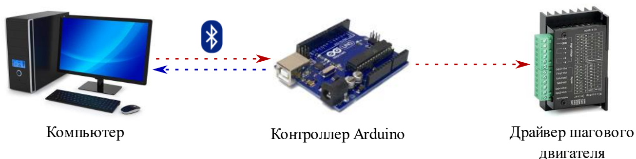
Рисунок 14. Схема передачи команд позиционирования в разработанной нами установке in situ .
