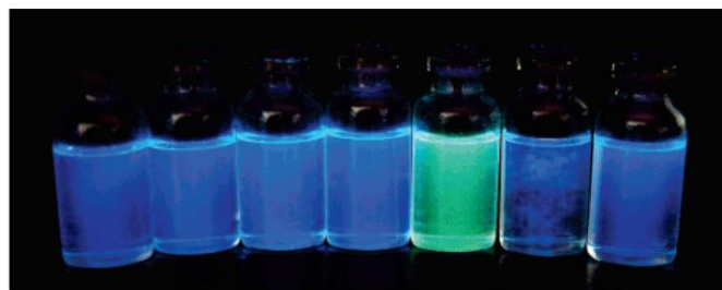
Рисунок 1. Слева: спектры испускания 18 в отсутствие катионов металлов и в присутствии 100-кратных избытков. \lambda_{\text{возб}} 350 нм. Справа: Флуоресценция растворов лиганда с катионами металлов, слева направо: 18 , 18 +Li + , 18 +Na + , 18 +K + , 18 +Mg 2+ , 18 +Ca 2+ , 18 +Ba 2+ .
