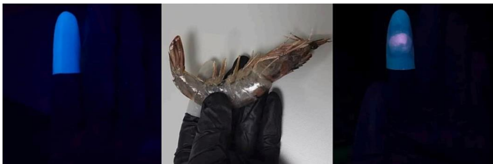
Рис. 47. Видимое изменение цвета излучения сенсорной перчатки до и после прикосновения к креветке, загрязненной \text{Hg}^{2+} . Рисунок взят и адаптирован из [155].
