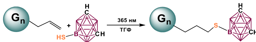
Рисунок 3. Общая схема синтеза бор-замещенных карборанкарбосилановых дендримеров G_1-8 cages, G_3-32 cages и G_5-128 cages по реакции гидротиирования.
