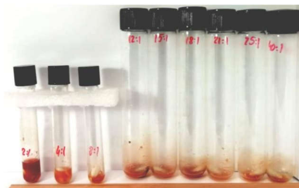
Рисунок 15. Фотография реакторов с реакционными смесями в отсутствие растворителя. Свободный объём закрытых пробирок содержит ограниченное количество O_2 воздуха. Соотношение объёма воздуха (мл) к количеству VnOH (ммоль) приведено на стенках пробирок.
