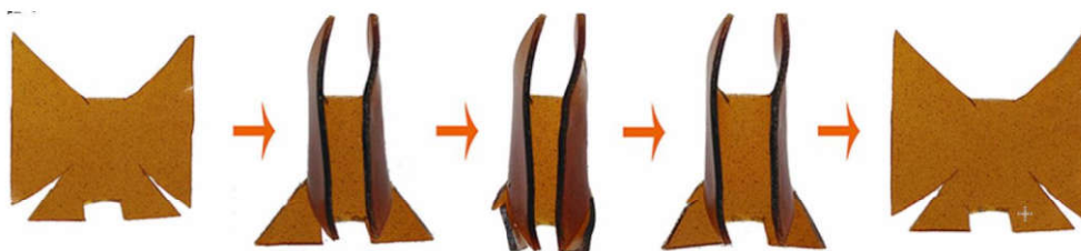
Рисунок 63. Эффект памяти формы бутадиенового сополимера, активируемый температурой [225]
