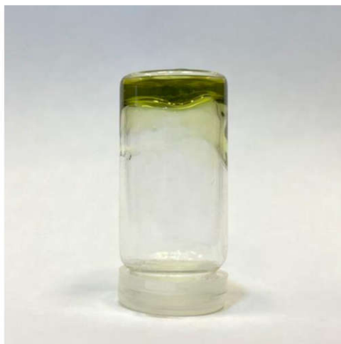
Рисунок 176. Фотография геля сшитого полимера в перевернутом виде через 5 секунд после смешения реагентов
