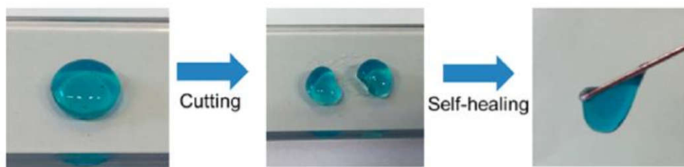
Рисунок 60. Самозаживление гидрогеля на основе гиалуроновой кислоты
