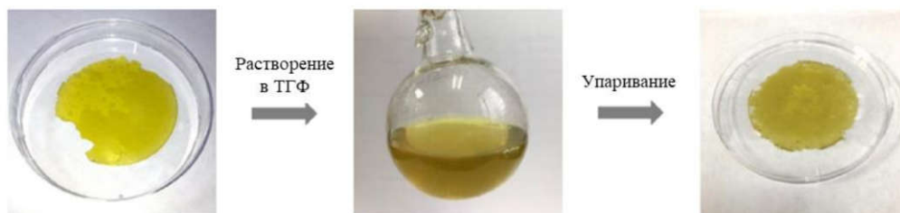
Рисунок 118. Эксперимент с растворением и повторным получением пленки полимера 35 b
