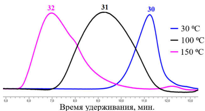
Рисунок 13. Кривые ГПХ образцов 30-32
