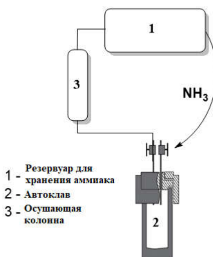
Рисунок 21. Схема установки для рецикла аммиака
