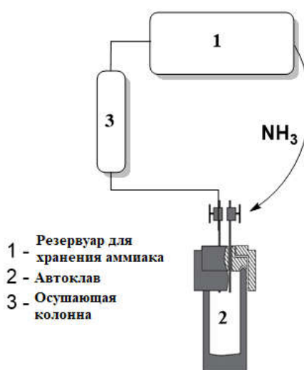
Рисунок 101. Схема установки для рецикла аммиака
