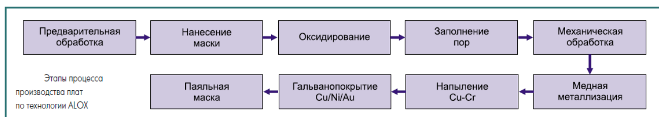
Рис. 1. Этапы процесса производства плат по технологии ALOX
