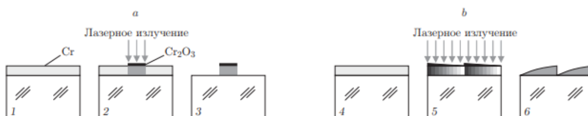
Рис. 6. Метод прямой лазерной записи (а) – бинарной структуры; (б) – полутоновой структуры
