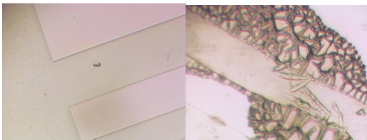
Рис. 67. Микрофотографии структуры в слоях фоторезиста ТАФХ+пиразолин до (слева) травления и после (справа) в 1% NaOH (Увеличение x10, ширина полос 40-100 мкм)
