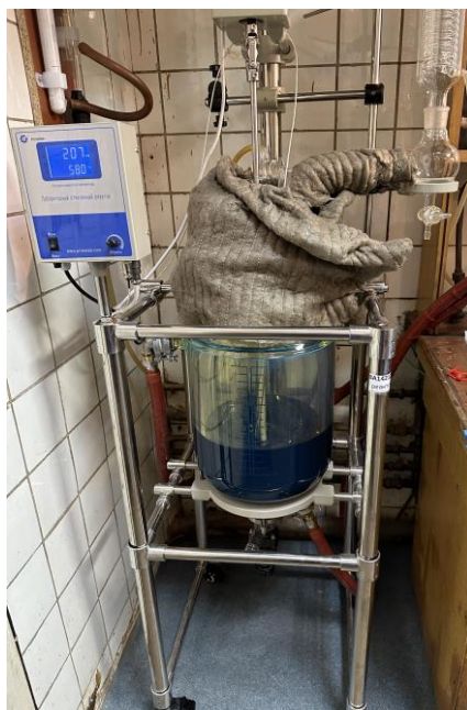
Рис. 45. Фотография химического реактора с раствором BTDA-AFL 0,5 :DABA 0,5 после его синтеза.
