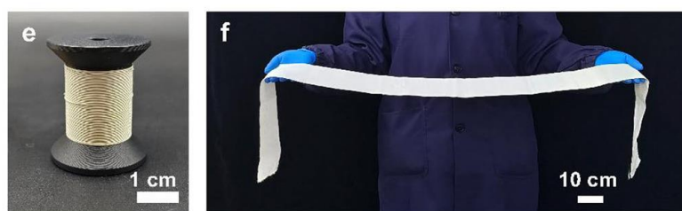
Рис. 27. Аэрогелевое волокно на основе 6FDA-ODA 0,5 :DABA 0,5 (адаптировано из [102]).
