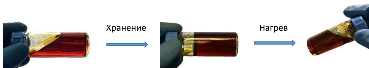
Рис. 49. Раствор PMDA-APH 0,5 :DABA 0,5 в N-МП после синтеза, гелеобразование при хранении и раствор после нагревания геля.
