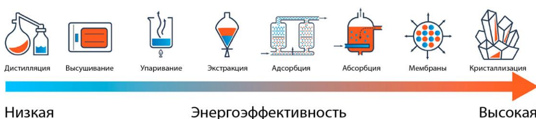
Рис. 21. Сравнение относительной энергии, необходимой для работы сепарационной установки, в диапазоне от высокой до низкой энергоэффективности (адаптировано из [153]).
