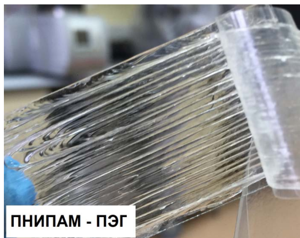
Рисунок 74 Сморщивание плёнок смесей ПВП – ПЭГ-400 (36%), ПВКЛ – ПЭГ-400 (45%) и ПНИПАМ – ПЭГ-400 (45%) после испытаний методом отслаивания.
