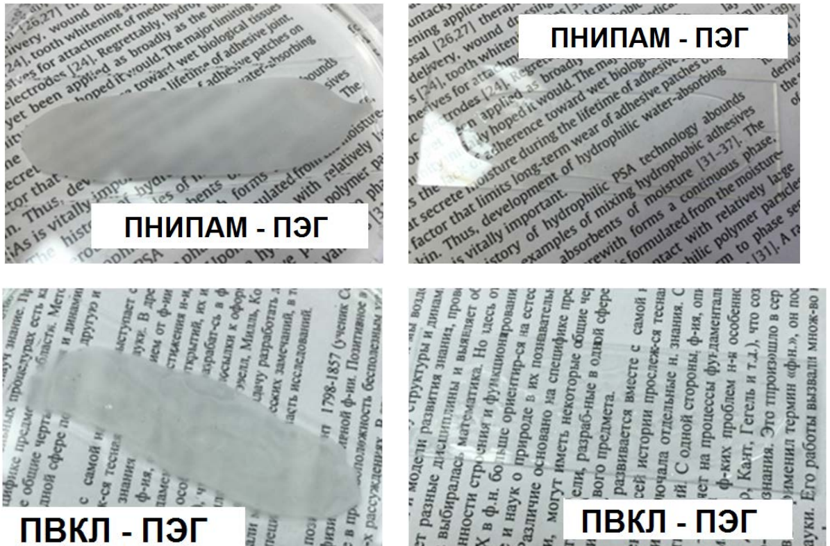
Рисунок 63 Фотографии плёнок ПВКЛ и ПНИПАМ с 45 мас. % ПЭГ-400 выше (слева) и ниже (справа) НКТС.
