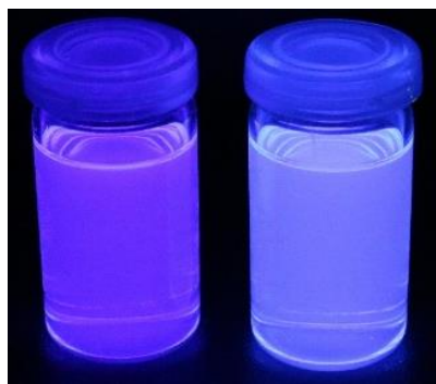
Рисунок 122. Фотография растворов Mono-DBMBF 2 (слева) и Mono-DBMBF 2 -OMe (справа) в дихлорметане при облучении светом с длиной волны 365 нм.
