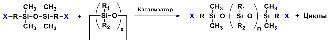
Рисунок 9. Схема синтеза телехелевых силоксановых олигомеров и полимеров.
