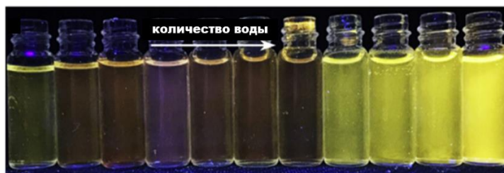
Рисунок 23. Фотография растворов бордифторидного комплекса, проявляющего агрегационно-индуцированную эмиссию при увеличении количества воды в смеси ТГФ-вода, при возбуждении светом 365 нм [132].
