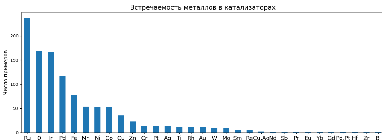
Рисунок 8. Частота встречаемости различных металлов в катализаторах. Сводка данных для реакций с выходом >65%.
