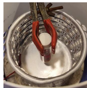
3. Вид сверху на установку фотореактора.
