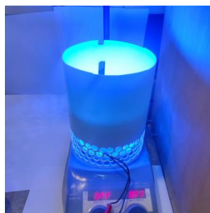
2. Установка фотореактора без охлаждающего вентилятора.
