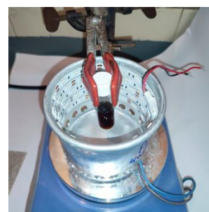
3. Вид сверху на установку фотореактора.
