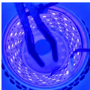
4. Вид сверху на установку фотореактора.
