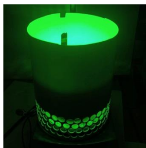
2. Фотореакторная установка без охлаждающего вентилятора
