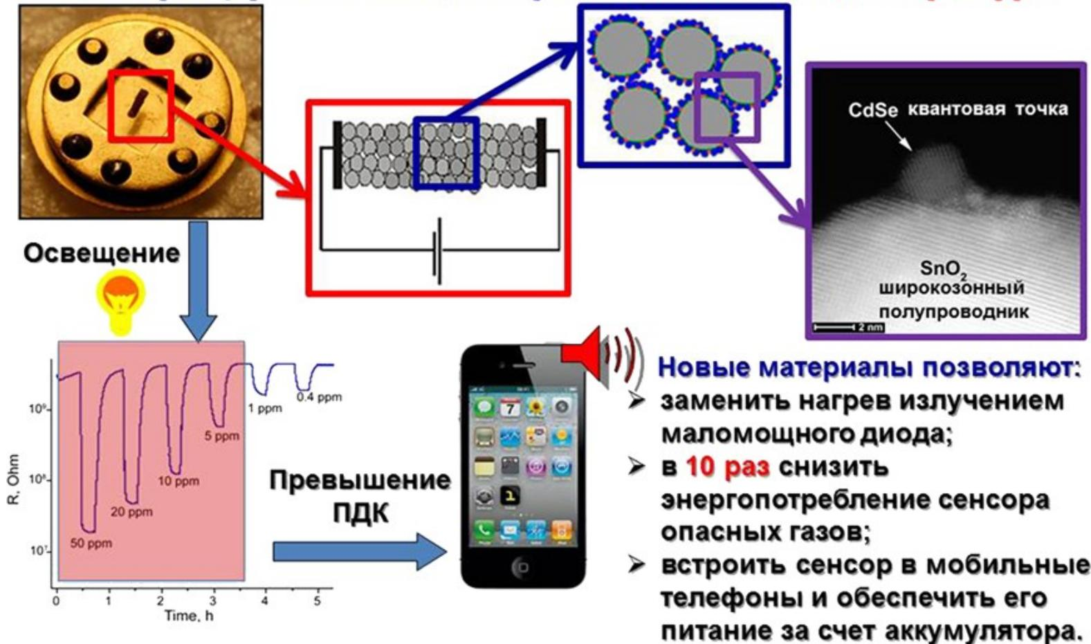
Роль **сенситизаторов** – квантовых точек полупроводников или проводящих органических материалов, заключается в увеличении концентрации носителей заряда в полупроводниковых оксидах при комнатной температуре, а также смещении диапазона оптической чувствительности полупроводниковых оксидов в сторону больших длин волн.
