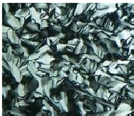
Рис. 1. Текстура, наблюдаемая в поляризованном свете для образца системы C_{12}EO_{10}/H_2O/Eu(TTA)_4-[BMIm][BF_4] , увеличение \times 100 (а), спектр люминесценции образца при \lambda_{\text{возб}} = 319 нм (б).
