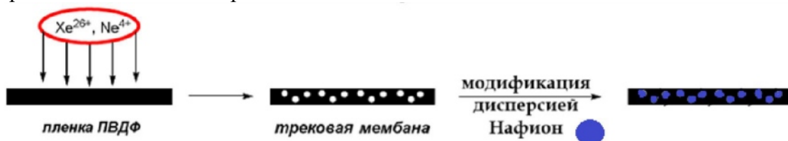
Рис. 1. Получение модифицированной трекинговой мембраны.
