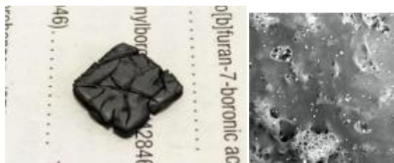
Рисунок 3. Вид объекта после пиролиза и данные сканирующей электронной микроскопии.
