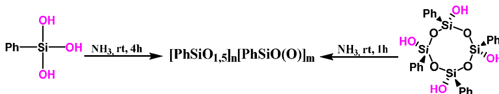
Рис. 1. Общая схема конденсации фенилсодержащих силанолов и силоксанолов в аммиаке.
