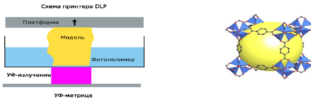
Рис.1. Схема 3D печати по технологии DLP – слева; схематическая структура MOF-5 – справа.
