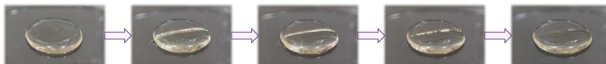
**Рисунок 17** – Самозалечивания образца из ПДМС №2.П при  $T_{\text{комн}}$  в течение 12 часов
