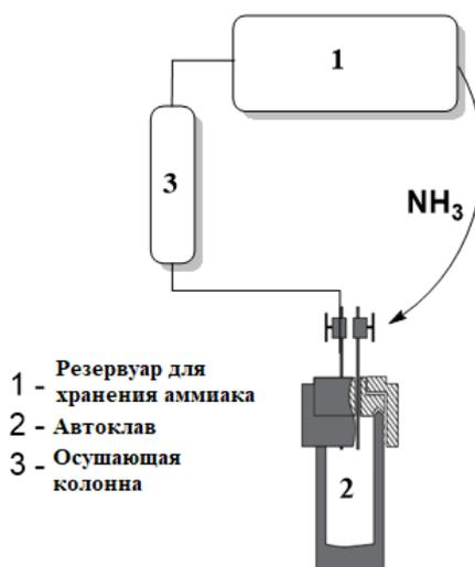
**Рисунок 28.** Схема установки для рецикла аммиака
